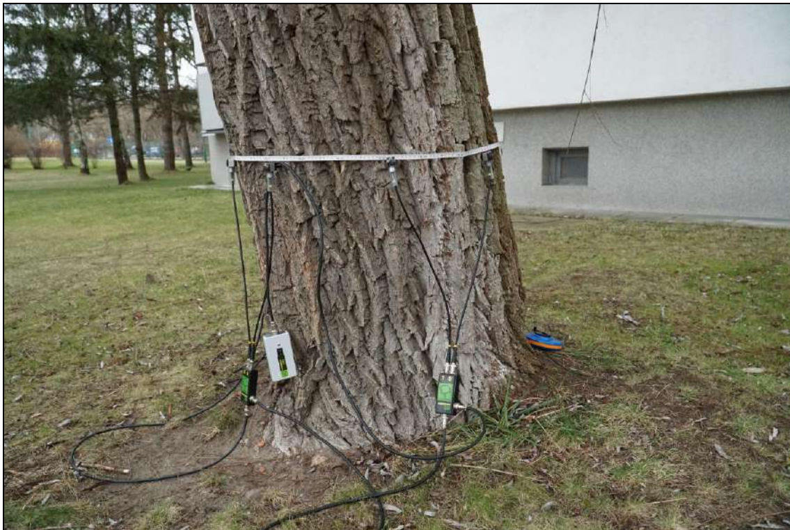
Fot. 3 Badanie tomografem akustycznym na wysokości 65 cm wykazało, iż powierzchnia objęta rozkładem wynosi 6% - niskie ryzyko (fot. T. Łyszcz, dn. 3.02.2025 r.)
