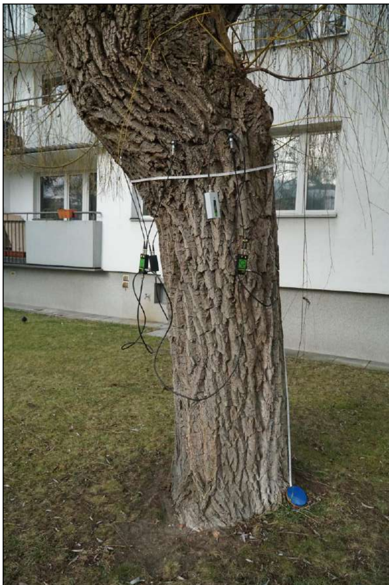
Fot. 2 Badanie tomografem akustycznym na wysokości 210 cm wykazało, iż powierzchnia objęta rozkładem wynosi 55% - niskie ryzyko (fot. T. Łyszcz, dn. 3.02.2025 r.)
